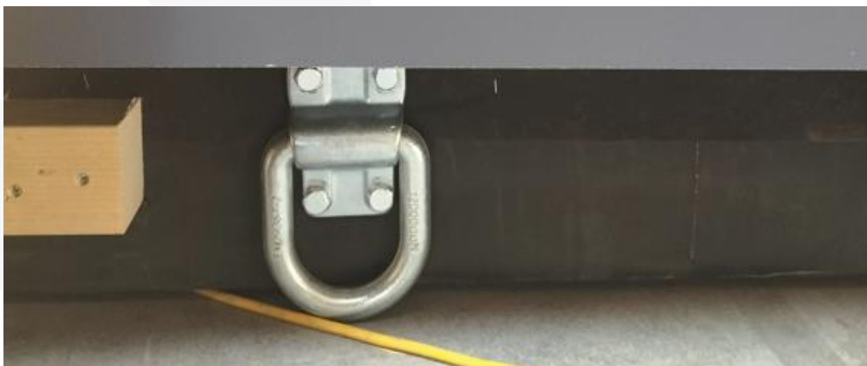
Rys. Przykład uchwytów do mocowania modułu do naczepy.
