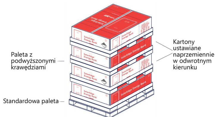
Rysunek 1: Przygotowana do transportu paleta z maksymalną liczbą czterech kartonów magazynów energii SolarEdge
