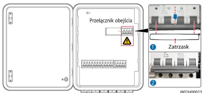
Rysunek 6-5 Wyłączanie przełącznika obejścia
