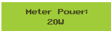
Rys. 7.36 Włączenie funkcji zerowego eksportu przez licznik energii
