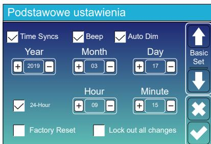
Reset do ustawień fabrycznych: Zresetuj wszystkie parametry falownika. Blokuj wszystkie zmiany: Włącz to menu, aby ustawić parametry, które wymagają zablokowania i nie można ich skonfigurować. Przed pomyślnym przywróceniem ustawień fabrycznych i zablokowaniem systemów, aby zachować wszystkie zmiany, należy wpisać hasło, aby umożliwić ustawienie.
