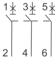
**Überstromschutzschalter verwendet (MCB) (2)**
