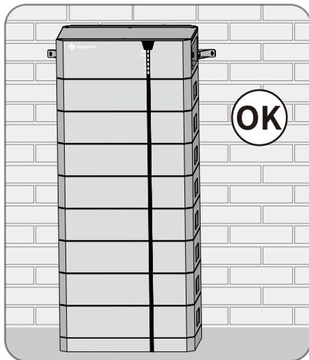
**Step 10:** Secure the hanger using screws(M8×40).
