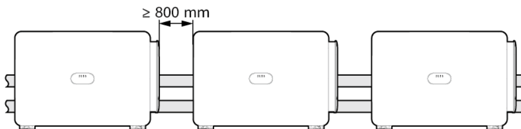
Rysunek 4-5 Montaż poziomy (zalecany)
