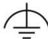
Przyłącze przewodu ochronnego wyrównania potencjałów
