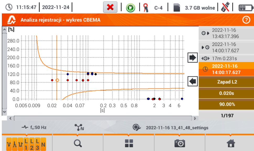
Rys. 5.27. Analiza rejestracji - wykres CBEMA
