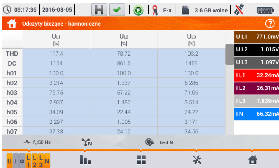
Rys. 5.18. Odczyty bieżące - harmoniczne - widok tabelaryczny
