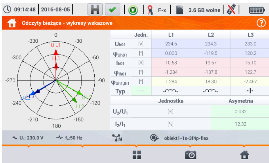
Rys. 5.16. Odczyty bieżące - wykres wskazowy
