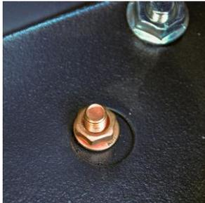
7 Erdungspunkte: Fronttür, Hintertür, beide Seitentüren, Boden an zwei Stellen, Dach)
