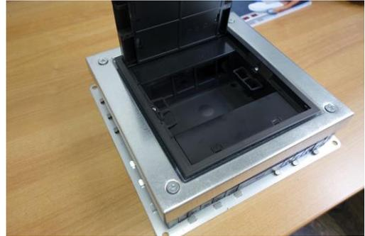
Die Abdeckung des Rahmens ist mit Blech verstärkt geeignet zum Verkleben von Teppichbelag bis ca. 7 mm dick, Montagehalter für Doppelbodenplatten mit einer maximalen Dicke von 30 mm. Die Rahmenmontagedose hat seitliche Bruchstellen zum Einführen von Kanälen oder Leitungen und stufenlose Tiefeneinstellung mittels Schrauben.
