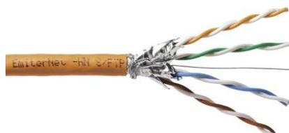
Das Kabel hat 4 Adernpaare (Adern aus reinem Kupfer) mit einer Farbmarkierung. Das Kabel ist mit Herstellerzeichen, Normkonformität und Längenmarkierung bedruckt: EmitterNet -HN S/FTP cat.7 1000 MHz LSZH-FR 23 AWG x 4PR, Verified to EN/PL 50173 ISO/IEC 11801 EIA/TIA 568-C.2 CE Brandverhalten: Dca-s1a-d2-a1 MM/JJ xxxm , mit MM/JJ – Monat und Jahr, xxx – Kabellänge
