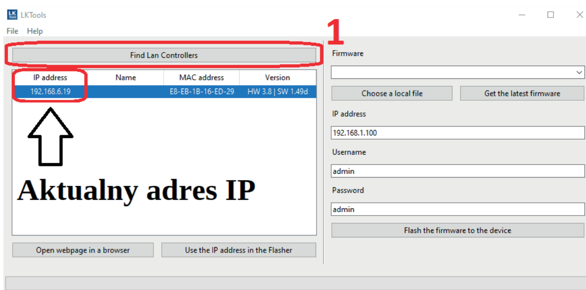
Rys. 7. Wyszukanie aktualnego adresu IP urządzenia w programie LKTools
