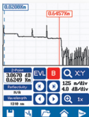
Ślad OTDR pokazany do szczegółowej analizy
