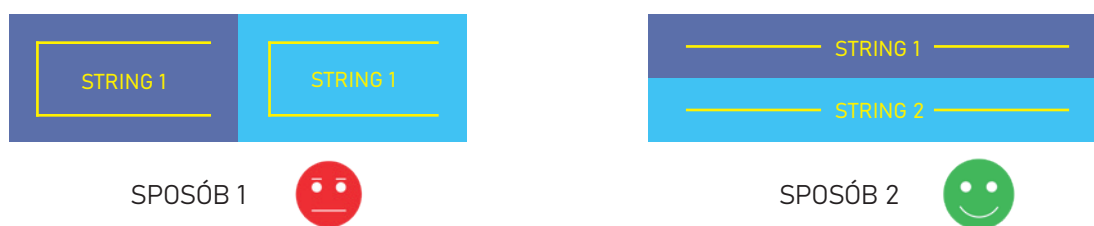
RYS. 4. OPTIMALIZACJA POŁĄCZENIA SYSTEMÓW MODUŁÓW
