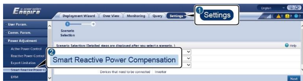
Rysunek 6-47 Ustawianie parametrów dla inteligentnej kompensacji mocy biernej
