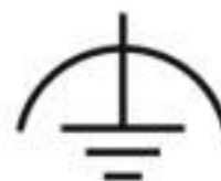
Przyłącze przewodu ochronnego wyrównania potencjałów
